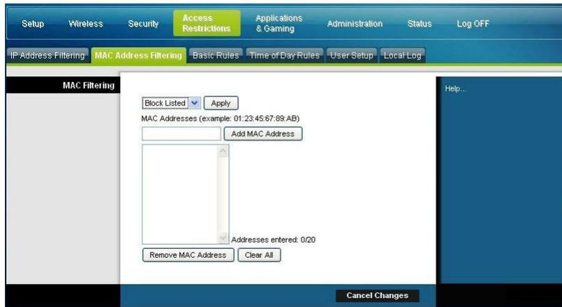
El menú desplegable Block/Pass (Bloquear/Permitir) le permite bloquear o autorizar el acceso a Internet a las direcciones MAC de los dispositivos que enumere en la tabla de filtros de direcciones MAC. En la tabla siguiente se describe la función del menú desplegable Block/Pass (Bloquear/Permitir). Tras seleccionar las opciones deseadas, haga clic en **Save Settings** (Guardar parámetros) para aplicar los cambios o en **Cancel Changes** (Cancelar cambios) para cancelar.
