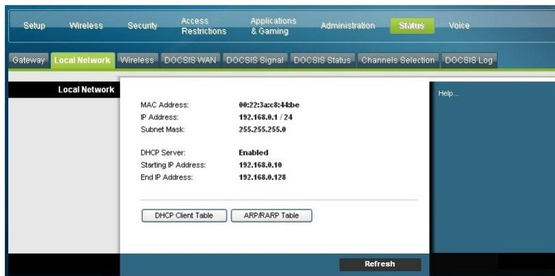
Utilice la tabla siguiente para revisar el estado del cable modem router y la conexión a Internet.
