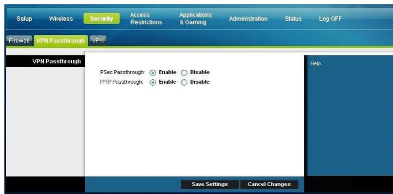
Utilice las descripciones e instrucciones de la tabla siguiente para configurar el paso a través de VPN del cable modem router residencial. Tras seleccionar las opciones deseadas, haga clic en **Save Settings** (Guardar parámetros) para aplicar los cambios o en **Cancel Changes** (Cancelar cambios) para cancelar.
