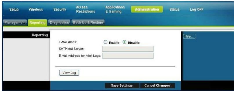
Utilice las descripciones e instrucciones de la tabla siguiente para configurar la función de informes del cable modem router. Tras seleccionar las opciones deseadas, haga clic en **Save Settings** (Guardar parámetros) para aplicar los cambios o en **Cancel Changes** (Cancelar cambios) para cancelar.
