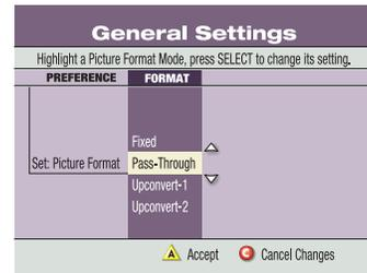
**Nota:** Cuando el conector HDMI está conectado al HDTV, la pantalla de **GENERAL SETTINGS - SET: PICTURE FORMAT (Ajustes generales - Configurar: Formato de imagen)** muestra la opción AutoDVI/HDMI en lugar de la opción Pass-Through.
