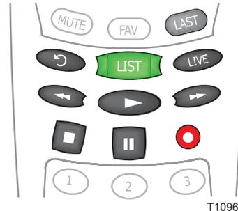
Cuando está reproduciendo en el modo normal, oprima **Rebobinar** o **Avance rápido** para pasar por tres velocidades distintas de rebobinado o avance rápido.
