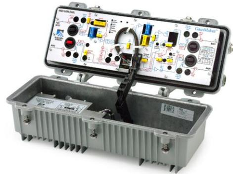
Les amplificateurs de système GainMaker utilisent la technologie GaAsFET dans l'interétage et les étages de gain de sortie pour améliorer les performances de distorsion.
