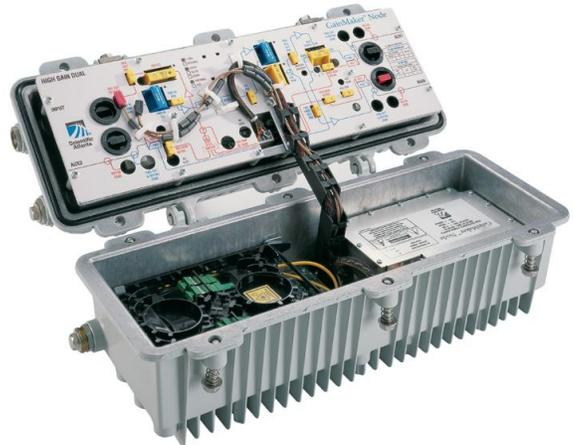
Cette version du nœud GainMaker est conçue avec la redondance RF pour s'adapter au chemin de transfert et à la redondance du chemin de retour via le câble coaxial pour vous protéger des coupures de fibre sur le réseau. Cette fonctionnalité est idéale pour les réseaux soumis aux contraintes de fibre qui veulent continuer d'être protégés par la redondance.
