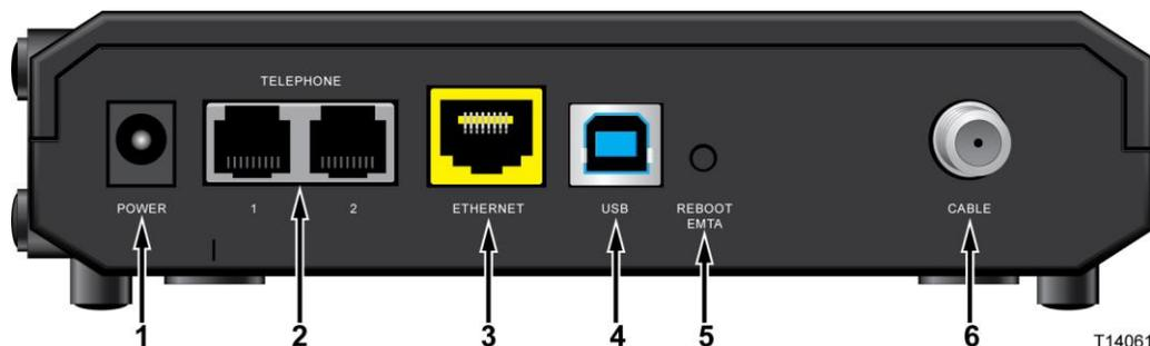
**切记：**请勿将 PC 同时与以太网端口和 USB 端口相连。如果以太网端口和 USB 端口同时连接到 PC，您的调制解调器将不会正常工作。
