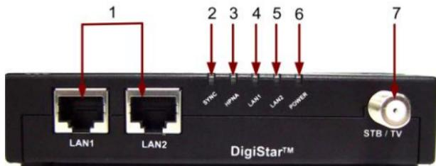
1. LAN1/LAN2接口 — RJ-45接口，连接网络设备的以太网接口；
