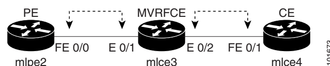
Figure 26-1 MVRFCE PE-CE Link
