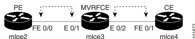
Figure 26-1 MVRFCE PE-CE Link
