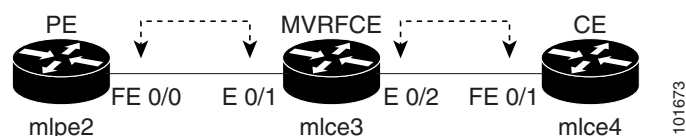
Figure 2-2 MVRFCE PE-CE Link
